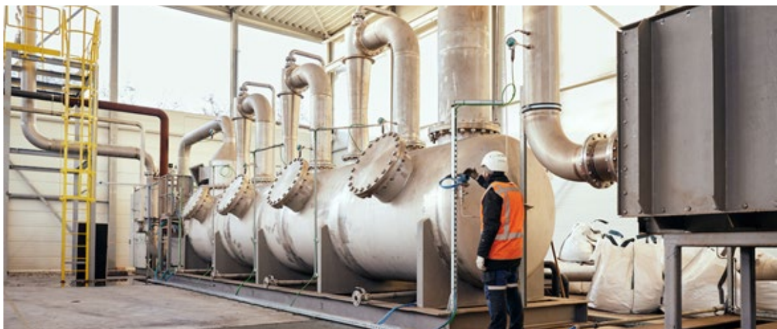
Opwerkingsinstallatie voor syngas
