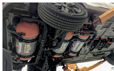
Figuur 38: Waterstofbrandstoftanks Hyundai Nexo en Toyota Mirai
