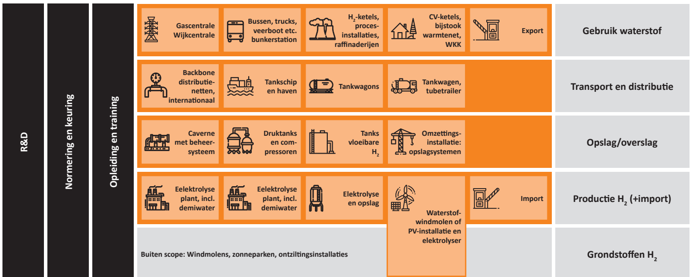
Figuur 8: systemen in waterstofketens
