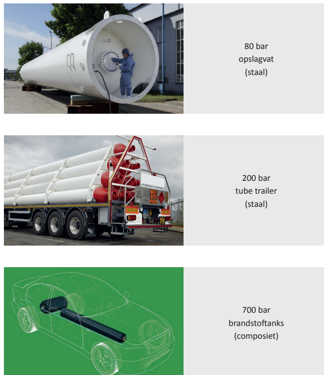
Figuur 33: Verschillende toepassingen en afmetingen van hogedruktanks voor waterstof
